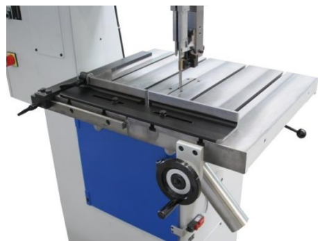
Manueller Vorschubtisch SSF420, mit Gewindespindel
