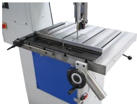
Manueller Vorschubtisch SSF 420, mit Gewindespindel
