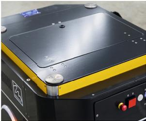
Die von Mössner entwickelte Hubeinheit ermöglicht es Lasten und Waren, um bis zu 60 mm anzuheben. Dies bietet dem AMR ein breiteres Einsatzfeld und erweitert den Aufgabenbereich.
