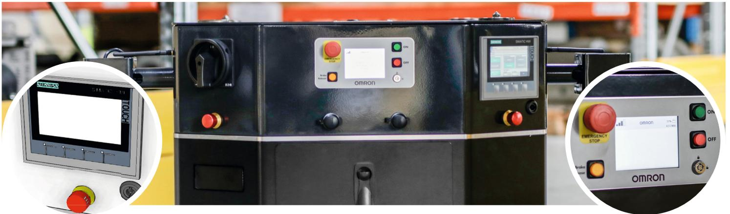
El PLC incorporado con HMI integrada actúa como interfaz entre el AMR y la unidad elevadora. La HMI permite el acceso manual al control del AMR para ejecutar funciones directamente en él.
