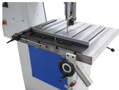
Manueller Vorschubtisch SSF 420, mit Gewindespindel
